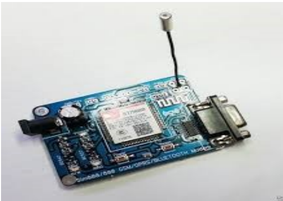
Fig 5. SIM 800A- GSM Modem
